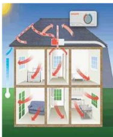
Figura 6.16 : Schema di un sistema solare ad aria calda
